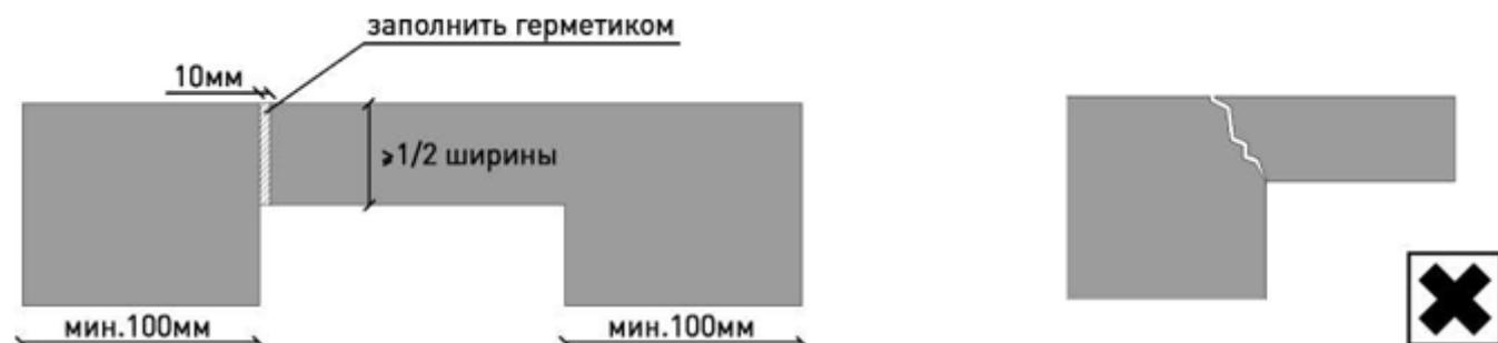
При резке Г-образной формы узкая часть должна составлять не менее 100 мм. При меньшей ширине необходимо разрезать панель в месте перехода, вставить соединительную планку и загерметизировать шов.
